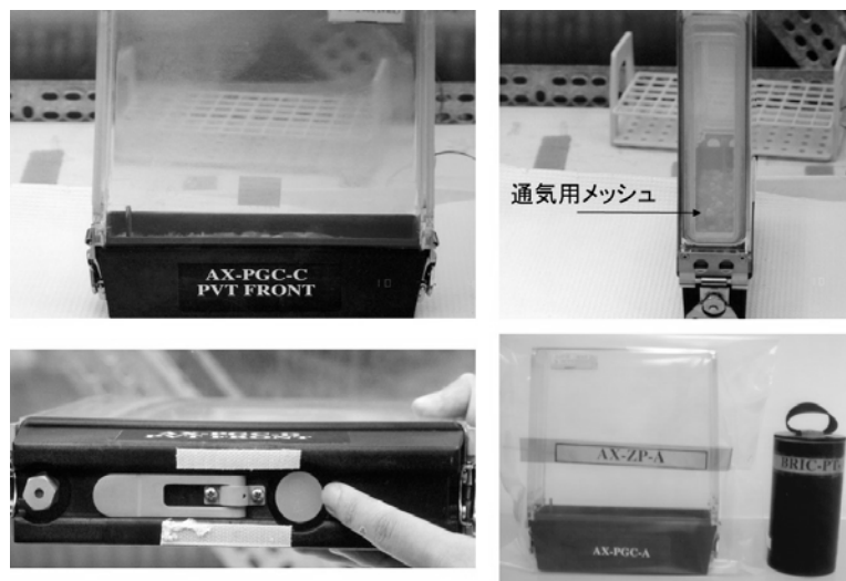
図 8. STS-95 植物宇宙実験で使用された培養容器 (Plant Growth Chamber) と BRIC 容器 (Biological Research in Canister) (右下写真の筒状の容器)。
