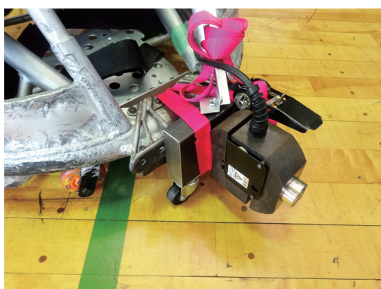
写真1 ロードセル取り付け状況
